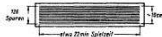
Bild 1. Die Anordnung der 128 Tonspuren auf dem 10 cm breiten Magnetband des Music-center matisch gestoppt. Durch Drücken einer Taste wird dann das Band mit der hohen Geschwindigkeit von rund 10 m/sec in die Anfangsstellung zurückgejagt. Man kann nun die nächste Spur wählen und neu starten.
