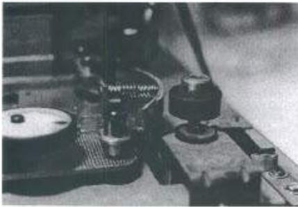
Der Mitnehmerteller, die Bremsbacke und das Antriebsrad für den Rücklauf.
